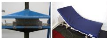
耐久テスト：厚さ低下率(27%) / 変形率(0%) 化学物質検出試験による「検出なし(初期検出)」
