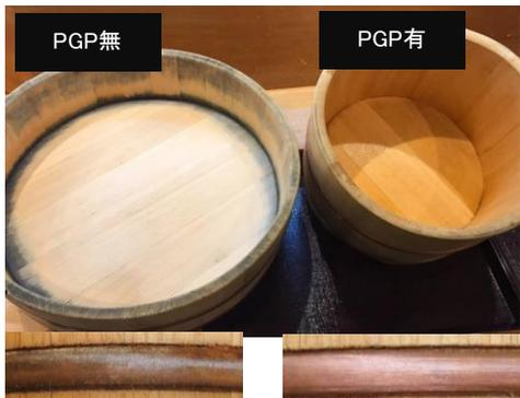
■ スチールによる 暴露試験 ※沖縄某沿岸部海水へ20日間浸水
